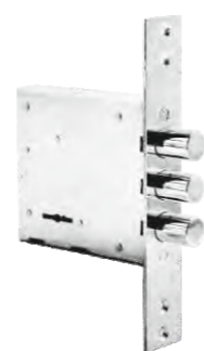
2 Border 3B8-8Г/15 дополнительный замок сувальдного типа 4 класс взломостойкости количество ригелей 3 диаметр ригелей 15,8 мм вылет ригелей 21 мм количество оборотов 2
