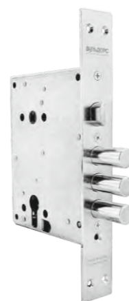
5 Border 3B4-3/85M основной замок цилиндрического типа 4 класс взломостойкости количество ригелей 3 диаметр ригелей 15,7 мм вылет ригелей 36 мм количество оборотов 3
