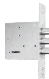
9 Guardian 30.01 дополнительный замок сувальдного типа 2 класс взломостойкости количество ригелей 3 диаметр ригелей 15,8 мм вылет ригелей 26 мм количество оборотов 2
