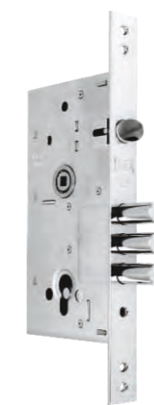
3 Kale 252 основной замок цилиндрического типа 4 класс взломостойкости количество ригелей 3 диаметр ригелей 16 мм вылет ригелей 34,5 мм количество оборотов 3
