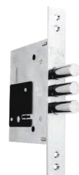
4 Kale 257 дополнительный замок сувальдного типа 4 класс взломостойкости количество ригелей 3 диаметр ригелей 16 мм вылет ригелей 35 мм количество оборотов 4
