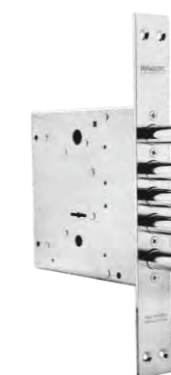
6 Border 3B8-8K5/15 дополнительный замок сувальдного типа 4 класс взломостойкости количество ригелей 5 диаметр ригелей 15,7 мм вылет ригелей 39,5 мм количество оборотов 4
