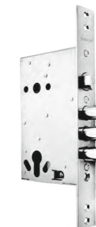
7 Border 3B4-3/85Г основной замок цилиндрического типа 4 класс взломостойкости количество ригелей 3 диаметр ригелей 15,6 мм вылет ригелей 23 мм количество оборотов 2
